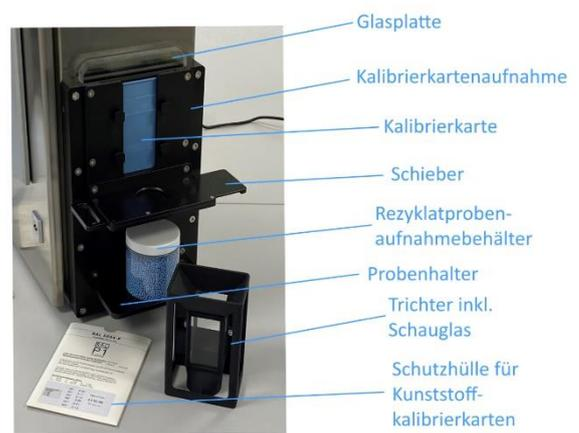
Auswerteeinheit inkl. Kalibrierkartenaufnahme, Glasplatte, Trichtereinheit, Kalibrierkarte inkl. Hülle, Rezyklatprobenaufnahmebehälter, +24V-Netzteil, Tastatur und Maus.
