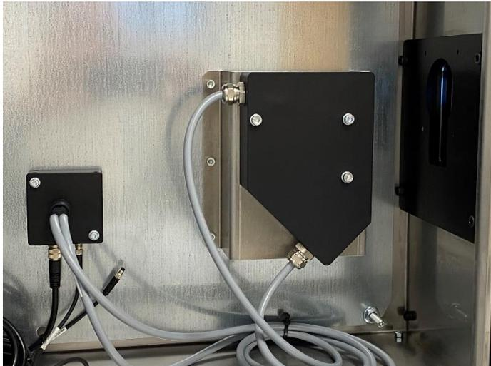
Das Messsystem ist hier in ein optisches Frontend sowie in eine Auswerteeinheit unterteilt. Das optische Frontend ist über zwei Lichtleiter (Sender- und Empfängerzweig) mit der Farbauswerteeinheit verbunden, die Farbauswerteeinheit verfügt über eine RS232 – Schnittstelle, mittels
