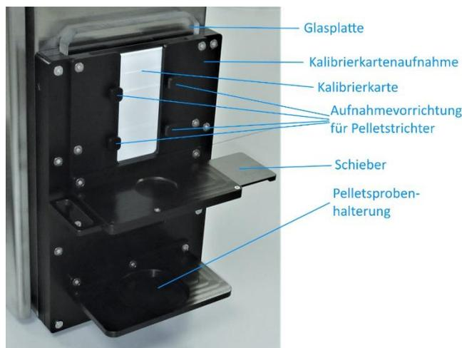
Die seitlich am Edelstahlgehäuse angebrachte Kalibrierkartenaufnahmeeinheit ermöglicht ein Kalibrieren der Farbsensorik auf die jeweilige Kalibrierkarte. Die Glasplatte befindet sich dabei unmittelbar vor der Kalibrierkarte und zwischen Kalibrierkarte und Farbsensorik. Nach dem Kalibrieren der Sensorik auf die jeweilige RAL – Kunststoffkarte (Kalibrierkarte) kann diese entfernt werden und stattdessen wird die Rezyklataufnahmeeinheit aufgesetzt.
